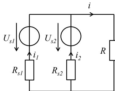
Les deux sources de tension réelles ci-dessus sont mises en parallèle et connectées à la résistance de charge  $R = 2.4 \Omega$ . On connaît les tensions  $U_{s1} = U_{s2} = 12 \text{ V}$  ainsi que les résistances internes  $R_{s1} = 1 \Omega$  et  $R_{s2} = 1.5 \Omega$
