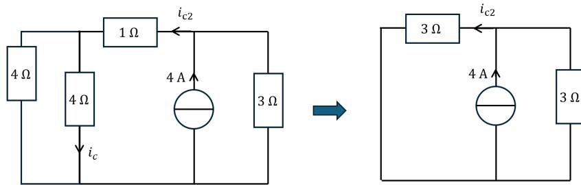
Par le diviseur de courant dans le circuit de droite on trouve  $i_{c2}$  :
