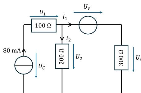
(a) Pour une tension  $U_V$  de 1 V, calculer la tension aux bornes de la source de courant
