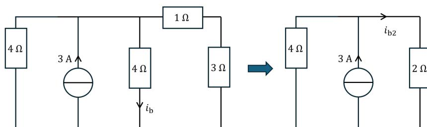
Par le diviseur de courant sur le circuit de droite on trouve  $i_{b2}$  :
