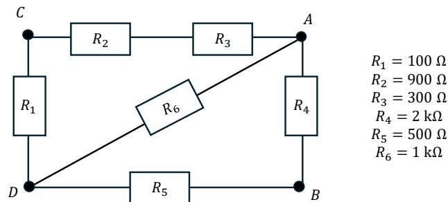
(a) Calculer la résistance équivalente  $R_{AB}$  vues des bornes A et B
